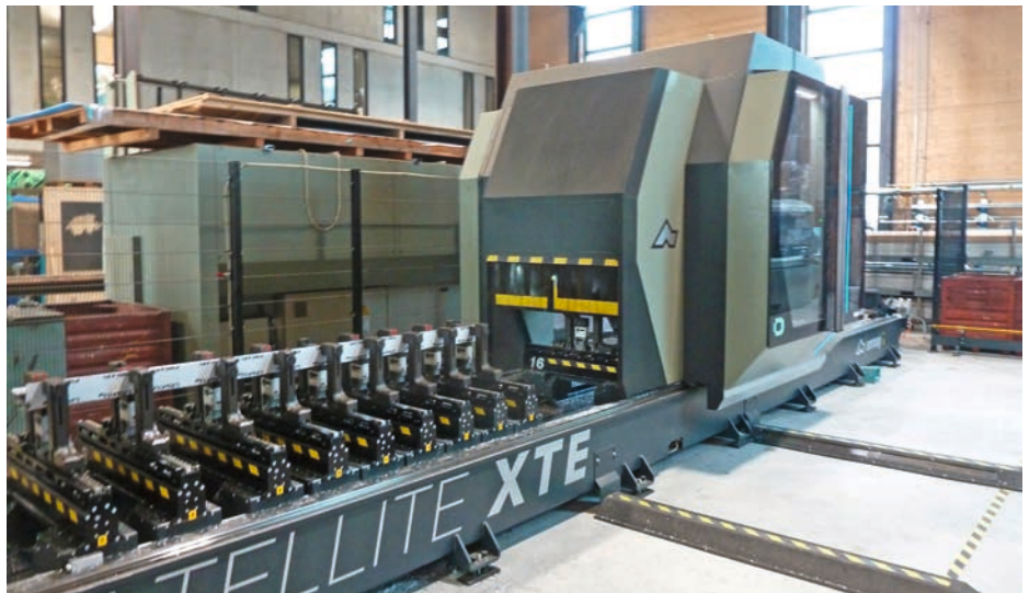
Die bestehenden Infrastrukturen wurden zielgerichtet mit neuen ergänzt. Das Bearbeitungszentrum mit fünf CNC-Achsen (im Bild) und eine Blech-Laser-Schneidanlage gehören zu den kostenintensivsten Investitionen.
