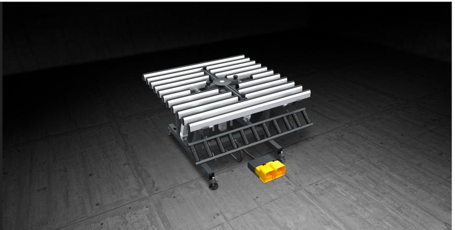
Verglasungspresse mit schwenkbarem Arbeitstisch, von 0° (horizontal) bis 85°. Kippbare und unabhängig von der Arbeitsfläche höhenverstellbare Rollenbahn (von 170 bis 460 mm). Arbeitstisch höhenverstellbar von 895 mm bis 965 mm. Füße mit Löchern zu Verankerung am Boden. Die Presse ist mit einem zentralen Hebekreuz für das Heben und Positionieren der Glasscheibe ausgestattet.
