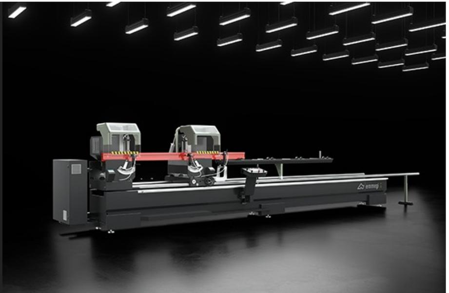
Tronçonneuse double tête électronique avec mouvement automatique de la tête mobile par moteur brushless actionné par contrôle numérique. Inclinaison pneumatique des unités de coupe en 3 positions fixes 90°, 45° et 22°30' (externe) ou avec système mécanique de réglage manuel des angles intermédiaires. Avance oléopneumatique de la lame.
