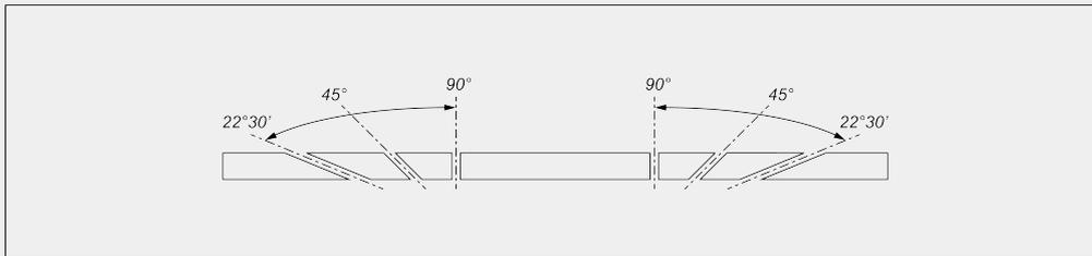
Réglage mécanique des angles intermédiaires
