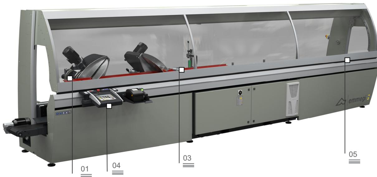
Doppelgehrungssäge mit 5 steuerbaren Achsen für Aluminium, PVC und Leichtmetalllegierungen mit automatisch ausfahrbarer Sägeeinheit und elektronischer Steuerung aller Gehrungen von 45° (innen) bis 15° (außen) mit einer Genauigkeit von 280 Zwischenpositionen pro Grad.
