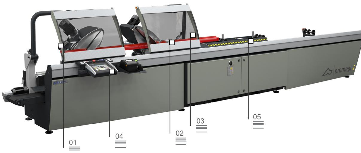
Doppelgehrungssäge mit 3 steuerbaren Achsen mit automatisch verfahrbarem Sägeaggregat und elektronischer Steuerung aller Gehrungen von 45° (innen) bis 15° (außen) mit einer Genauigkeit von 280 Zwischenpositionen pro Grad.
