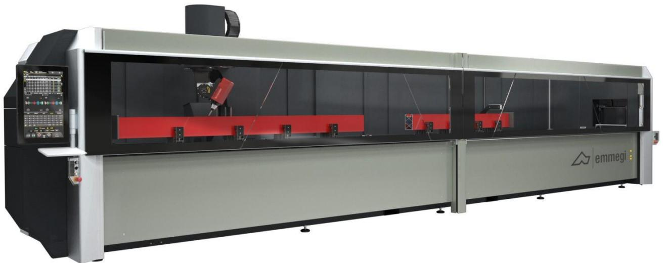
Centre d'usinage CNC à 5 axes commandés, conçu pour l'usinage de barres ou de pièces en aluminium, acier, PVC, et alliages légers en général. Il possède deux modes de fonctionnement, le premier qui comporte une zone d'usinage unique pour des barres jusqu'à 7,7 m de long, le second qui comporte deux zones d'usinage autonomes.
