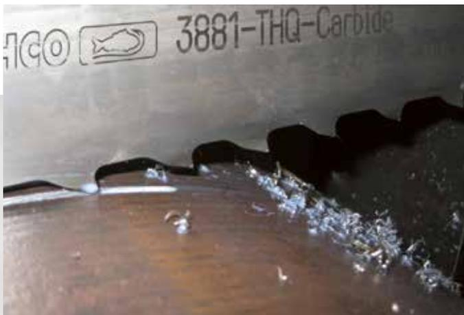
Entwickelt für Speziallegierungen, insbesondere für Materialien, bei denen das Sägeband leicht verkleben kann, wie Inconel, Waspaloy, Titan und Nickel-Basis Legierungen. Eignet sich auch gut für Edelstahl und Werkzeugstähle.
