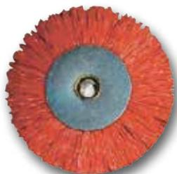
Zur Reinigung von Zahnzwischenräumen der Sägebänder, um eine optimale Schneidleistung des Bandes zu gewährleisten. Durch richtigen Einsatz der Spanbürste verlängert sich die Standzeit des Bandes.
