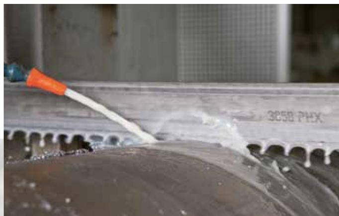
Zum Hochleistungssägen härterer Materialien, sowie größerer und schwer zerspanbarer Werkstücke. Mit speziellem Zahndesign für eine optimale Sägeleistung und Geräuschreduzierung.
