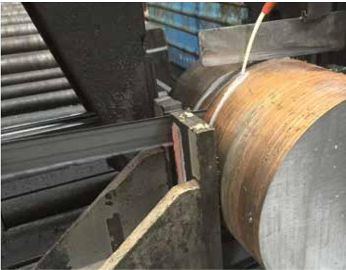
Zum hocheffizienten Sägen schwer zerspanbarer und abrasiver Materialien, insbesondere für Werkstücke aus Edelstahl, bei denen Vibrationen auftreten können. Dieses Sägeband wird werkseitig nach einer patentierten Methode „voringefahren“, was ein schwingungsarmes Sägen ab dem ersten Schnitt ermöglicht. Durch die Hoch/Tief 3-Zahngeometrie und den guten Freischnitt werden Zahnausbrüche verhindert. Ermöglicht das Schneiden von Werkstücken bei extrem niedrigem Geräuschpegel.
