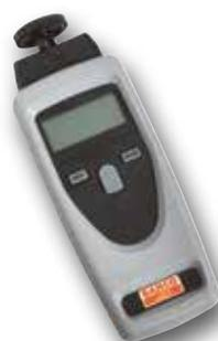
Zur sofortigen Bestimmung der Bandgeschwindigkeit auf einem LED-Display. Misst in m/min & ft/min.
