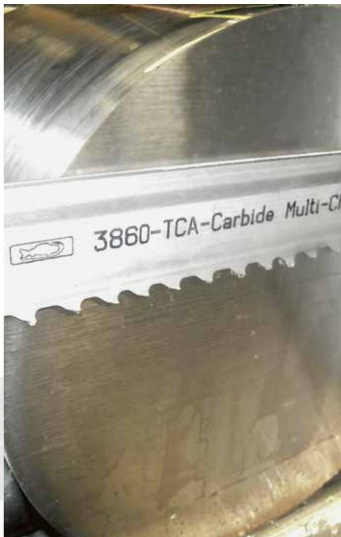
Spezielles Sägeband für Aluminium.
