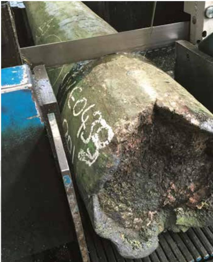
Zum hocheffizienten Sägen schwer zerspanbarer und abrasiver Materialien. Dieses ungeschränkte Hartmetallsägeband eignet sich besonders für abrasive Materialien wie Inconel und Titan.
