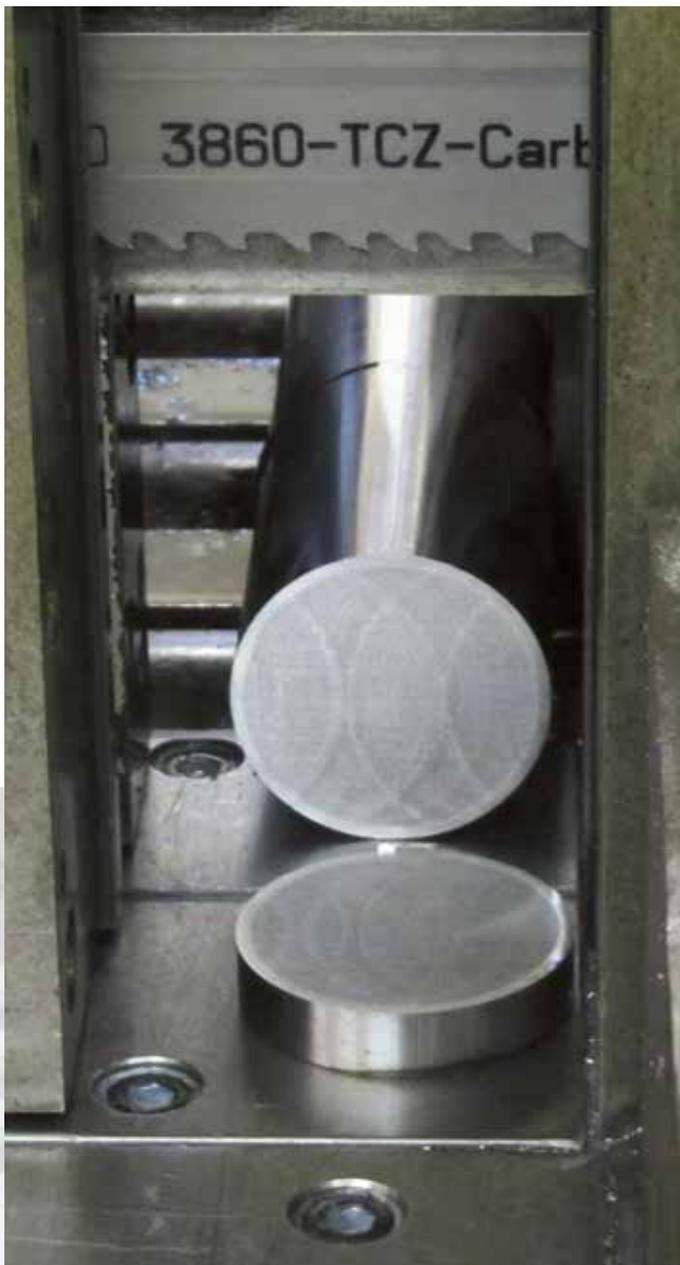
Das 3860 TCZ wurde zum Sägen von randschicht-gehärteten Wellen entwickelt, die auch verchromt sein können.
