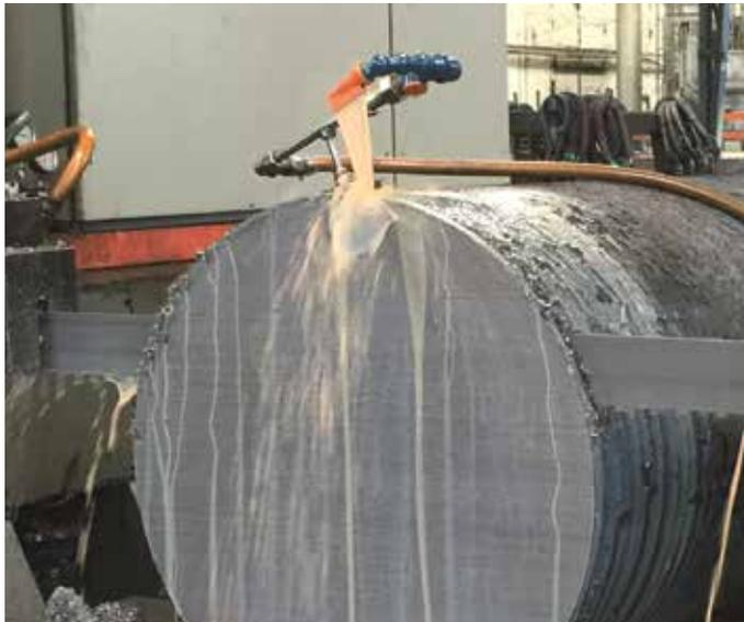
Aggressives Zahndesign mit extrem positivem Spanwinkel. Hohe Spankapazität bei schwer zerspanbaren Materialien wie rostfreiem Lagerstahl, Werkzeugstählen und schwer zu bearbeitenden Speziallegierungen.
