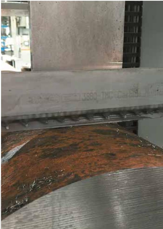
Diese 54 mm und 67 mm TMC Sägebänder werden in beschichteter Ausführung geliefert.
