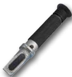
Die richtige Konzentration des Kühl-Schmierstoffes ist genauso wichtig wie die Bandgeschwindigkeit oder der Vorschub. Mit dem Refraktometer lässt sie sich leicht überprüfen.
