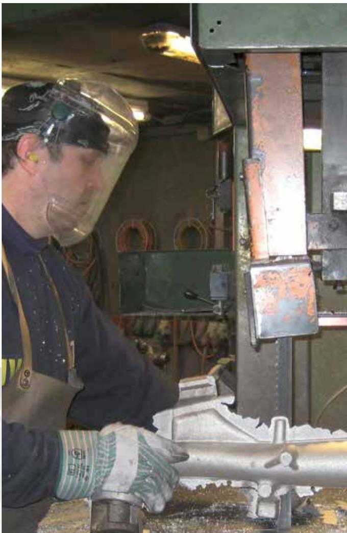
Zum Sägen von Nichteisenmetallen und abrasiven Materialien. Ideal geeignet zum Sägen von Aluminiumstrukturen, Magnesium, Zirkon, Kunststoffen und anderen abrasiven Materialien. Spezielles Design für Gießereianwendungen.
